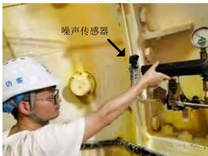
图 5 灯泡体故障实验图
